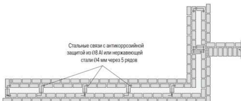
Рис.1.2.33 в. Фрагмент 1. Армирование диафрагм.
